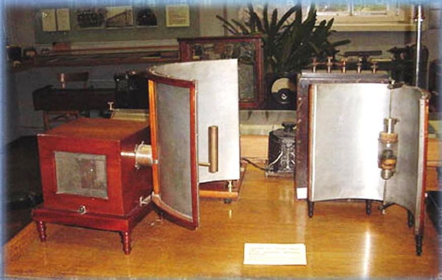
Аппаратура А.С. Попова 1896г. (Когерерный приемник и излучатель)
